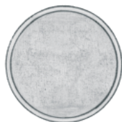
Erosion noch zulässig, Teller nachpolierbar
