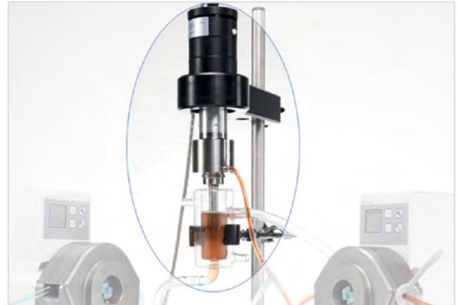
Beispielaufbau mit Durchflusshorn FZ 7 G und Durchflussgefäß DG 5
