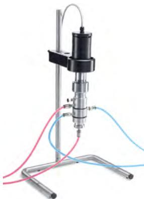
Beispielaufbau mit Durchflussgefäß DG 4 G
