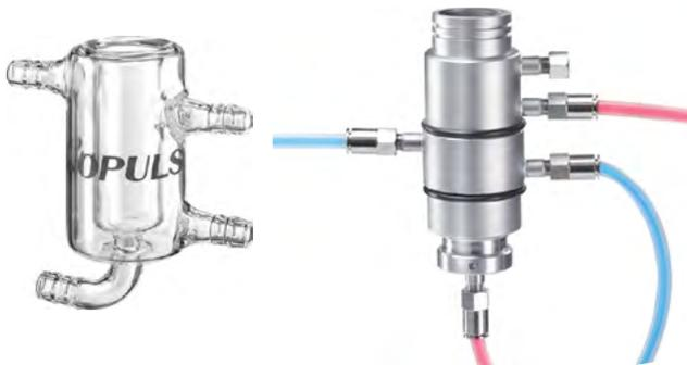
Durchflussgefäße DG 5 aus Glas und DG 4 G aus Edelstahl zum dichten Anschluss an das Boosterhorn
