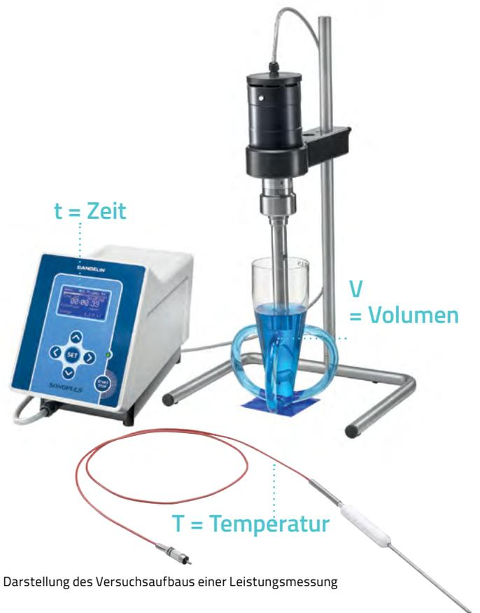
Darstellung des Versuchsaufbaus einer Leistungsmessung
