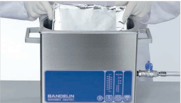
Feuille tendue sur un cadre de test
