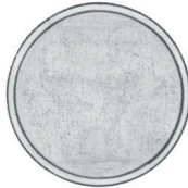
Erosion noch zulässig, Teller nachpolierbar
