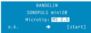
Falls der angezeigte Sonotrodentyp mit der montierten Sonotrode nicht übereinstimmt, muss vor den folgenden Schritten mit dem Drehgeber der korrekte Sonotrodentyp eingestellt werden. Durch Drücken der Taste "START/STOP" wechselt das Menü in den Bereitschaftsmodus und der Ultraschallhomogenisator ist funktionsbereit. Es werden die beim letzten Betrieb verwendeten Parameter wieder eingestellt und angezeigt.
