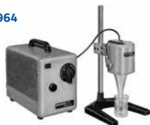
Fertigung der ersten Ultraschallhomogenisatoren mit Röhrentechnik
