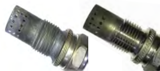
Zündkerze vor und nach der Reinigung im Ultraschallbad
