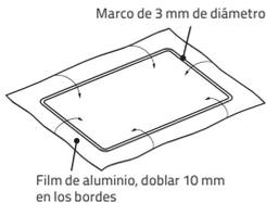
4. Con los ultrasonidos desactivados, coloque o fije, en caso necesario, el marco del test de film revestido en diagonal, centrado en la cubeta oscilante (véase el vídeo).
