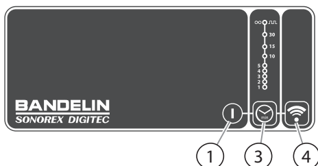
Rys. 3 Elementy sterujące do myjek ultradźwiękowych bez nagrzewania
