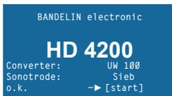
Durch Drücken der Taste "START/STOP" wechselt das Menü in den Bereitschaftsmodus (Pausemodus) und der Ultraschallhomogenisator ist funktionsbereit. Es werden die beim letzten Betrieb verwendeten Parameter wieder eingestellt und angezeigt. Wurde der Ultraschallwandler zwischenzeitlich gewechselt, werden die früheren Einstellungen durch Standardwerte ersetzt und müssen neu editiert werden. Die Temperaturanzeige wird nur sichtbar bei angeschlossenem Temperaturfühler.
