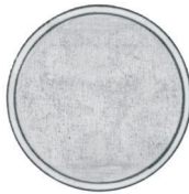
Erosion noch zulässig, Teller nachpolierbar
