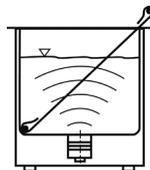
Des cadres pour test à la feuille appropriés peuvent être commandés auprès de BANDELIN electronic GmbH & Co. KG. Les cadres pour test à la feuille sont conçus pour une large gamme de dimensions de cuves. Une feuille d'aluminium est également nécessaire pour réaliser le test. Elle n'est pas comprise dans le matériel fourni.
