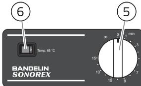
Fig. 4 Éléments de commande du modèle RK 31 H
