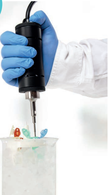
Refroidissement par glace pilée
