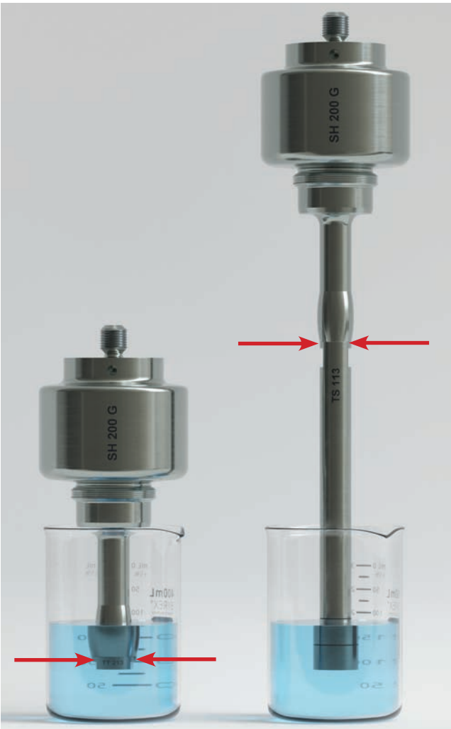
Raccord à vis corne/plateau en titane et corne/sonotrode, cylindrique
