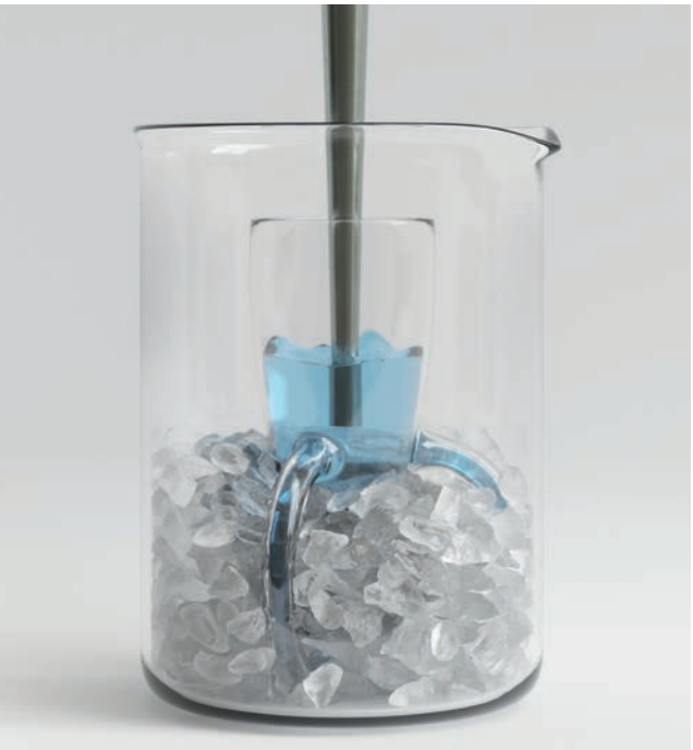
Refroidissement de l'échantillon dans une cellule en rosette RZ avec de la glace pilée
