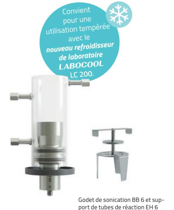
Godet de sonication BB 6 et support de tubes de réaction EH 6
