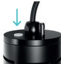
Sur le transducteur à ultrasons se trouve en outre une prise de raccordement pour l'utilisation d'une sonde de température pour la surveillance de la température de l'échantillon.
