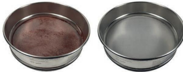
Tamis d'analyse avant et après le nettoyage
