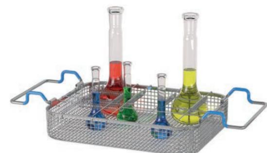
Support de fioles de laboratoire ZF, monté dans le panier suspendu
