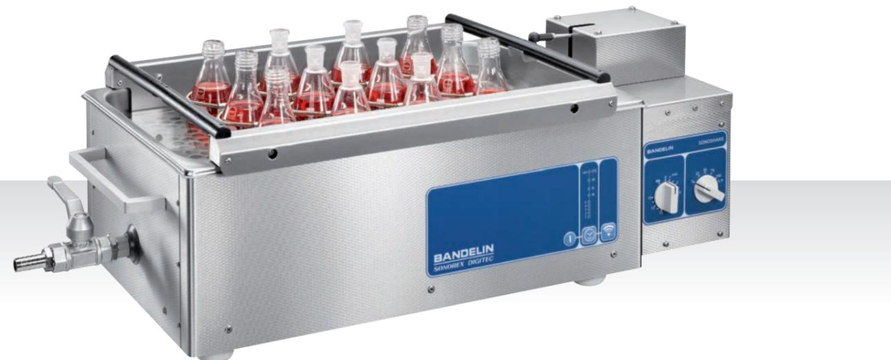
SONOSHAKE - combinaison d'un bain à ultrasons plat et d'un agitateur
