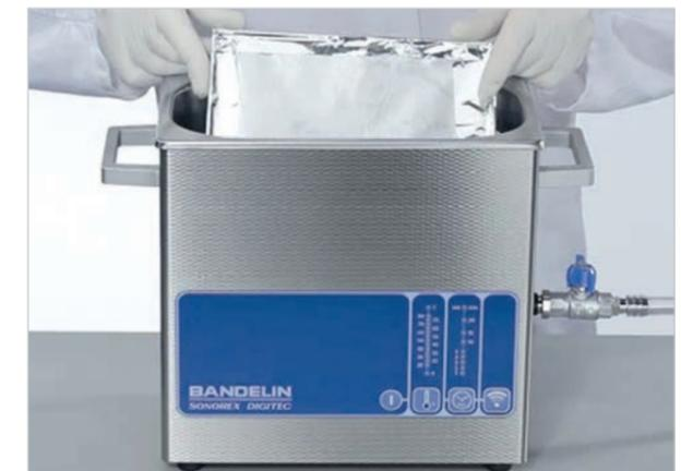
Auf einem Folienteststrahlen aufgespannte Folie
