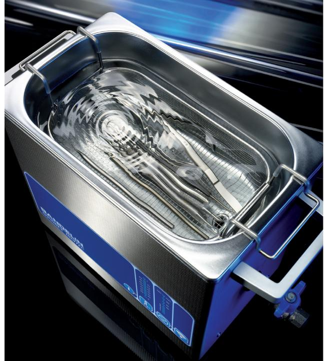
Die Temperatur kann einen signifikanten Einfluss auf die Reinigungsleistung haben. Eine Erwärmung der Reinigungslösung vorzugsweise auf 40 – 60 °C beschleunigt den Reinigungsvorgang in vielen Fällen erheblich.
