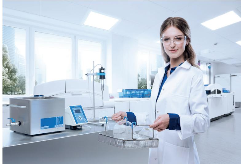
Saubere Laborgläser oder z. B. Analysensiebe sind heute im Labor, speziell im Analyselabor, eine Grundvoraussetzung für genaue und reproduzierbare Analysenergebnisse. Der Einsatz von SONOREX-Ultraschallbädern in Kombination mit den für die Ultraschallreinigung speziell entwickelten TICKOPUR-Präparaten ersetzt hier aufwendige manuelle Arbeiten.
