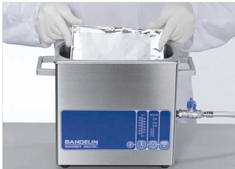
Auf einem Folientestrahmen aufgespannte Folie
