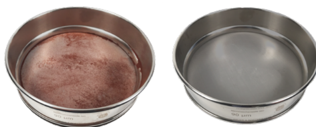
Analysensieb vor und nach der Reinigung
