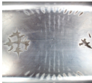
Beispiele von Kavitationserosion am Wannenboden
