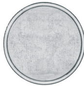
Erosion noch zulässig, Teller nachpolierbar
