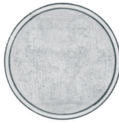
Le degré d'érosion est encore admissible, plaque polissable
